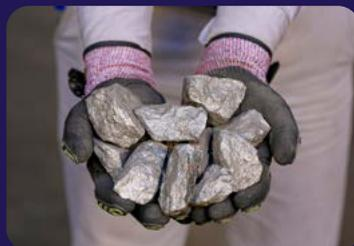
Utilizado como agente de liga na produção de aço, garantindo alta resistência a corrosão e temperaturas extremas para ligas metálicas, o ferronióbio é essencial para as indústrias automobilística, naval, petroquímica e de infraestrutura, impulsionando novas tecnologias industriais.
